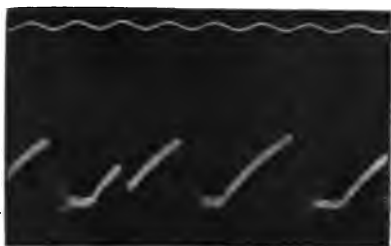
Abb. 286a. Primärer Strom eines Funkeninduktors bei Hammerunterbrecher.
